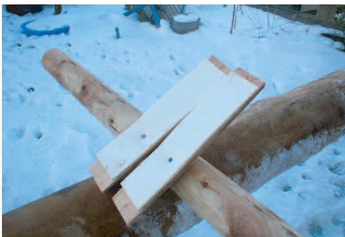
Cambium Pads mit den Anpresshölzern
