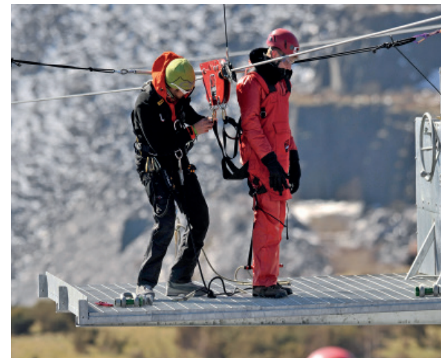
©Zip Wold. Manuell betriebene Ein- und Ausstiegsbühne. In weniger als 8 Sekunden hebt sie sich an und senkt sich wieder ab
