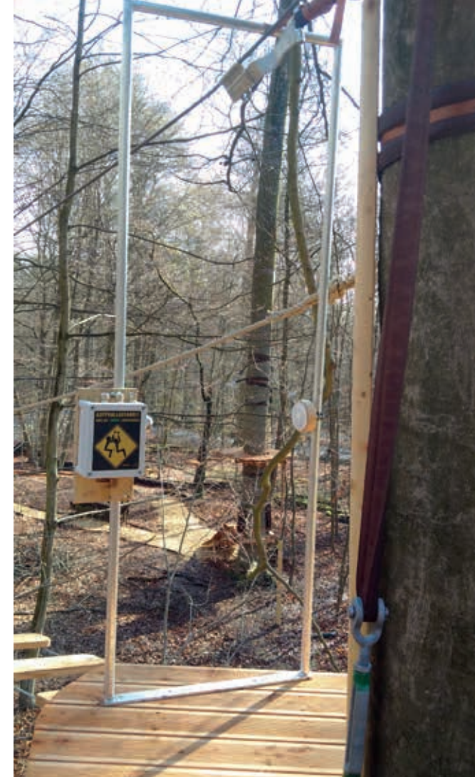
Lichtschranke auf der Startplattform Foto: Cambium GmbH
